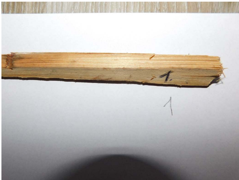
Foto 7.5. – Vzorek V1 – bez viditelné koroze dřeva
