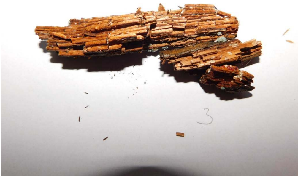
Foto 7.69. – Charakter konstrukce krovu východní části objektu (úroveň 4.NP) – vzorek V3 – viditelné napadení dřeva římsy dřevokaznou houbou stupeň H3
