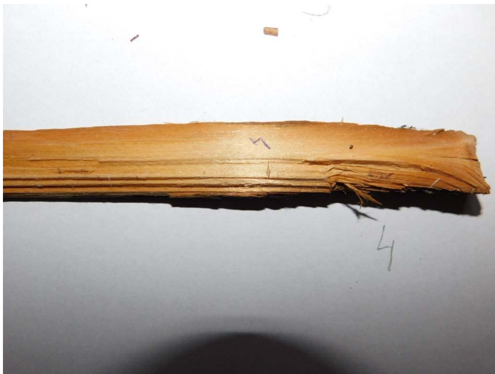
Foto 7.62. – Charakter konstrukce krovu východní části objektu (úroveň 4.NP) – vzorek V4 – bez viditelné koroze dřeva
