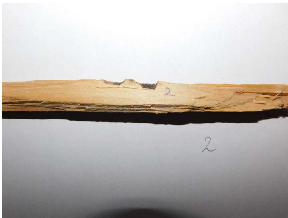
Foto 7.12. – Sonda K3 (úroveň 3.NP) – vzorek V2 – bez viditelné koroze dřeva
