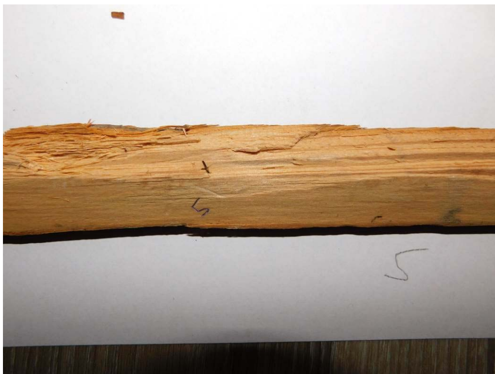
Foto 7.71. – Charakter konstrukce krovu východní části objektu (úroveň 4.NP) – vzorek V5 – viditelné napadení dřeva krokve dřevokaznou houbou stupeň H1
